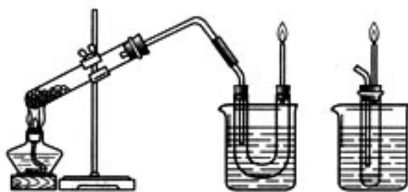
图 2-12 利用废旧泡沫塑料制燃油、燃气
