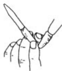
图 3-11 除去碱式滴定管胶管中气泡的方法
