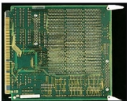
图 5 10 用酚醛树脂底板制作的集成电路板
