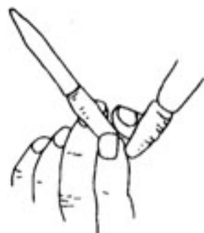
图 3-13 除去碱式滴定管胶管中气泡的方法
