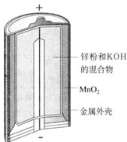
图 4-3 碱性锌锰电池的构造
