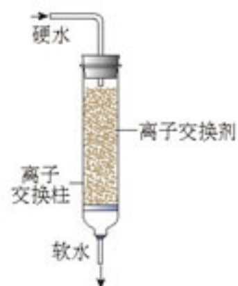
图 2-1 离子交换法软化水示意图
