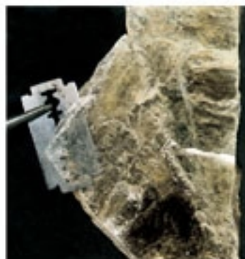
(b) 云母中 [\text{SiO}_4] 连结对平面层状结构
