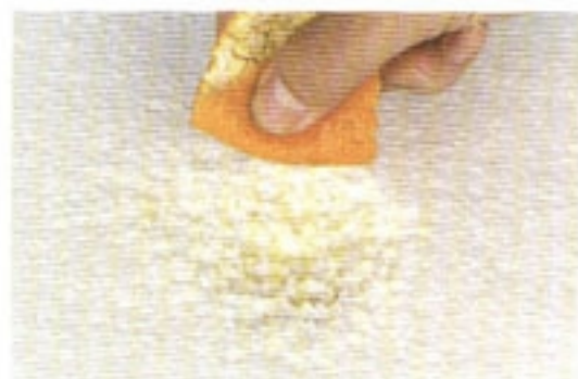
图 4-45 泡沫塑料的溶解实验
