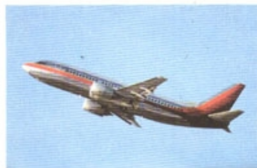
图 3-6 硬铝常用于制造飞机的外壳
