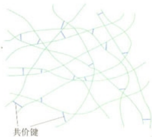
图 3-39 热固性塑料硬化后的体型网状结构
