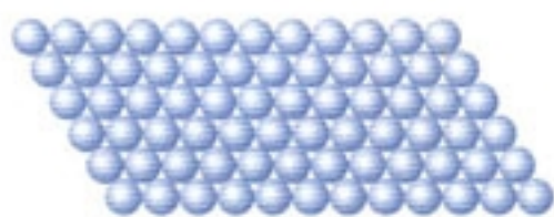
纯金属内原子的 排列十分规整
