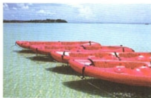
图 3-44 玻璃钢制成的船体
