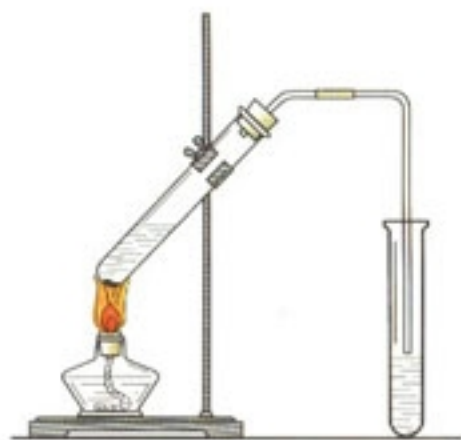
图 3-17 生成乙酸乙酯的反应
