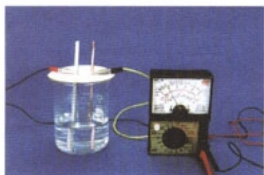
图 2-9 原电池示意图
