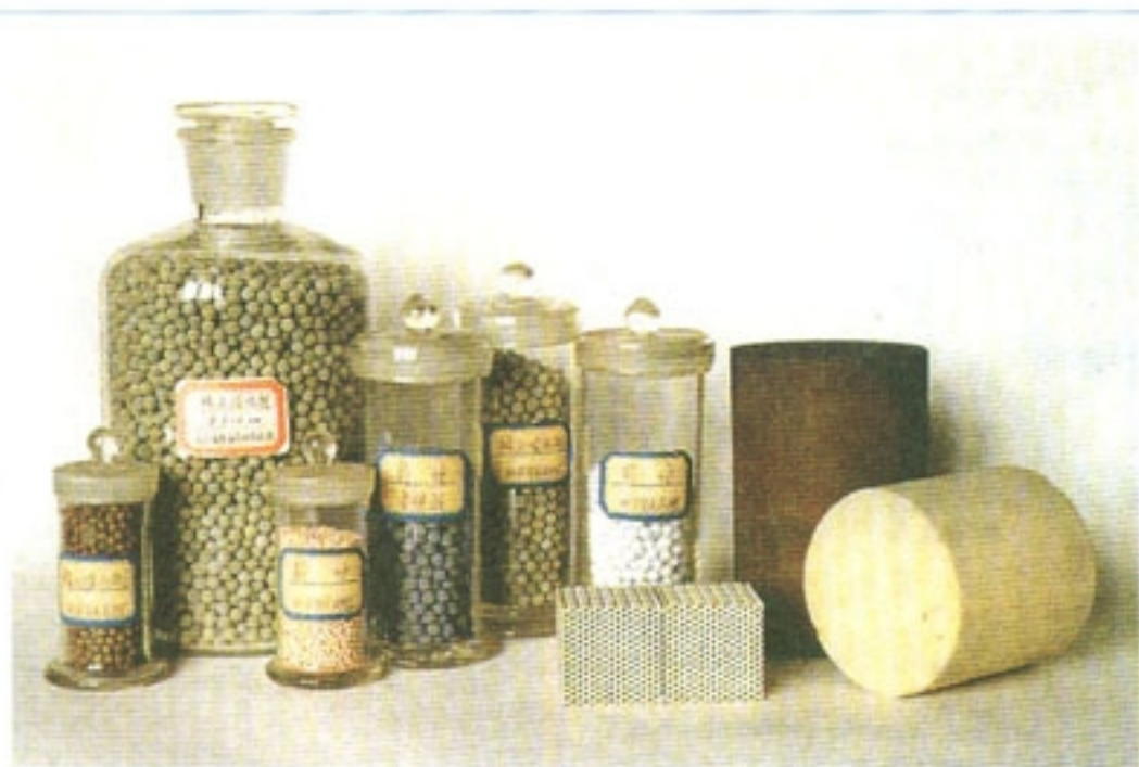
图 2-18 净化汽车尾气的催化剂及其载体
