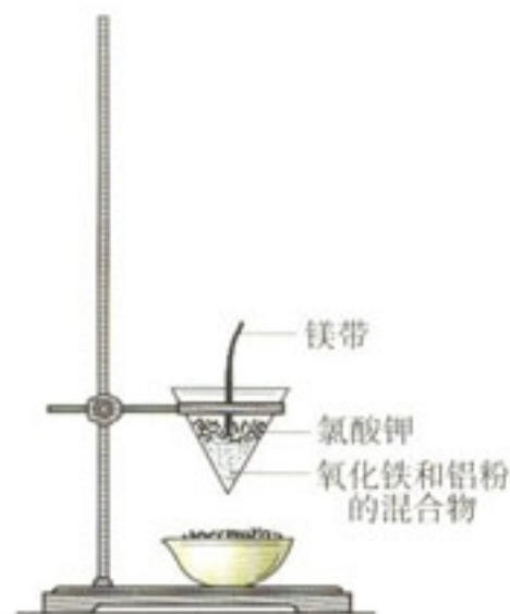
图 4-1 铝热反应的实验装置
