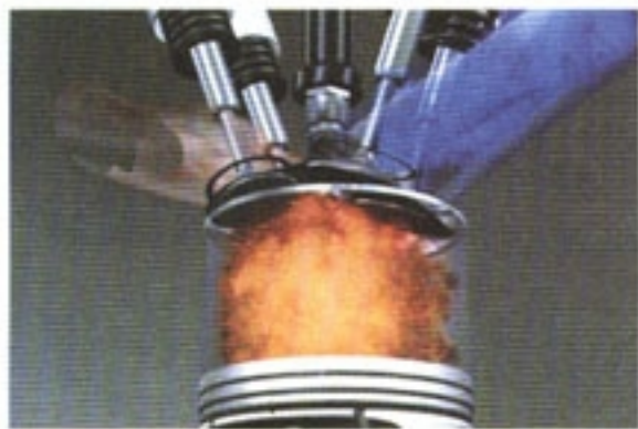
图 2-5 汽车发动机汽缸中燃料燃烧
