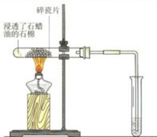
图 3-7 石蜡油分解实验
