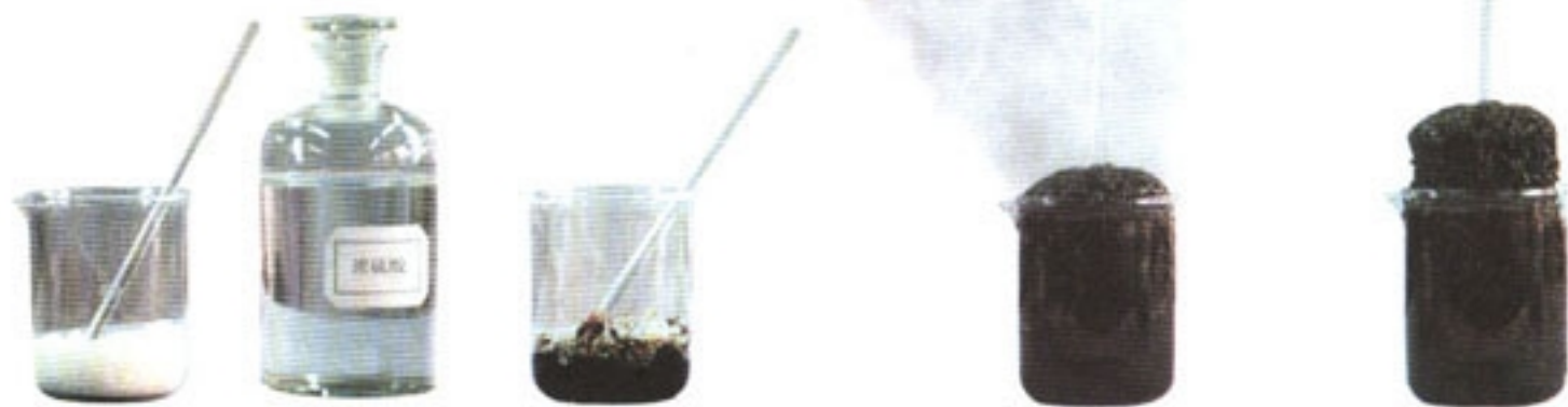
图 4-31 向蔗糖中加入浓硫酸时，蔗糖变黑，体积膨胀，变成疏松多孔的海绵状的炭，并放出有刺激性气味的气体
