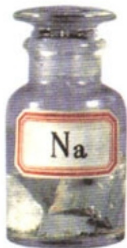
图 3-3 钠常常保存在石蜡油或煤油中
