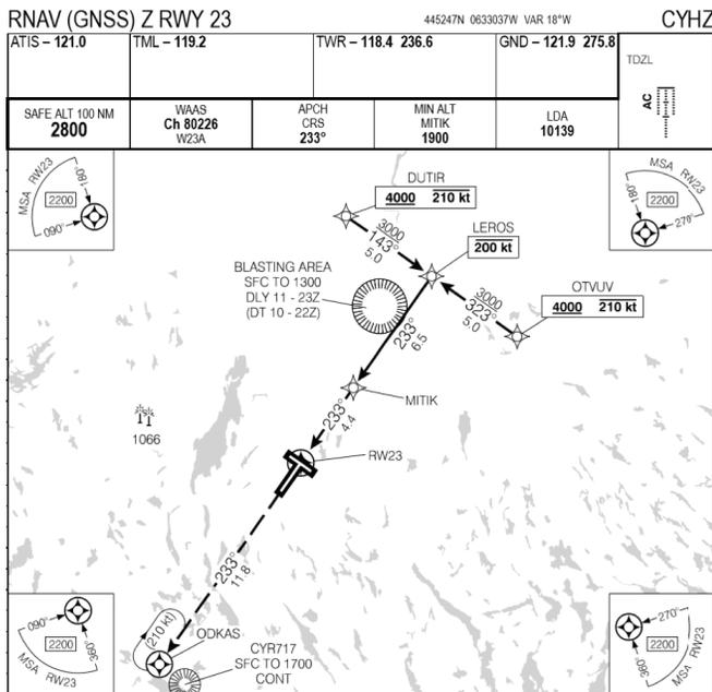
**Figure 9.6 – Transitions avec « RF requis » d'un IWP à gauche et à droite vers un FAWP à CYHZ, RNAV (RNP) Y piste 23 (Non disponible en français)**
