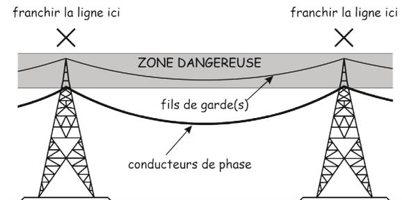
La figure ci-dessus illustre bien ce point. L'ensemble de conducteurs de phase porteurs de courant se compose de plusieurs gros câbles. Ces conducteurs de phase lourds qui pendent ont un diamètre d'environ 2 po et sont très visibles. Ils distraient souvent les pilotes qui, alors, ne voient pas les fils parafoudre ou les fils de garde supérieurs, lesquels sont d'un diamètre beaucoup plus petit et pourraient ne pas être visibles.
