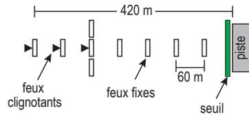
**Balisateur lumineux d’approche à moyenne intensité avec feux indicateurs d’alignement de piste (MALSFR) :** Ce dispositif lumineux d’approche à intensité variable s’étend sur 720 m à partir du seuil de piste et se compose de :
