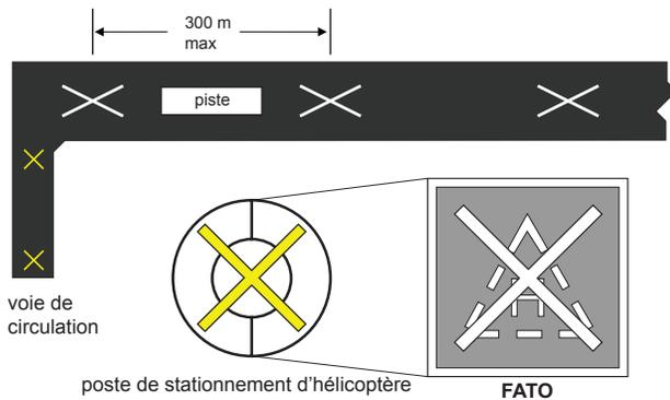
Une marque en forme de «X» lumineuse peut aussi être placée à 75 m du seuil pour marquer la fermeture temporaire d'une piste au complet.
