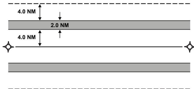
**Figure 2.7b) – Coupe transversale d'une route RNAV fixe**
