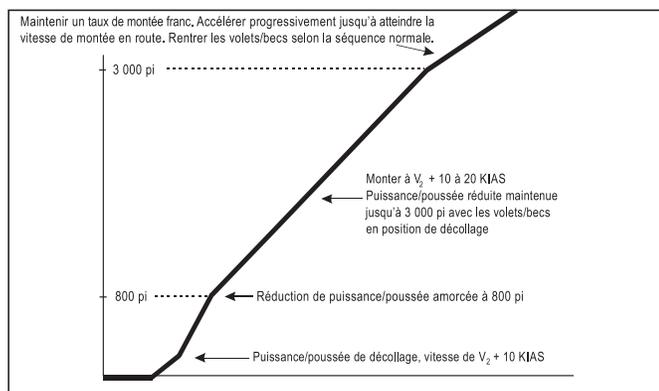
Montée au décollage en mode atténuation du bruit — Exemple de procédure atténuant le bruit à proximité de l'aérodrome (NADP 1)
